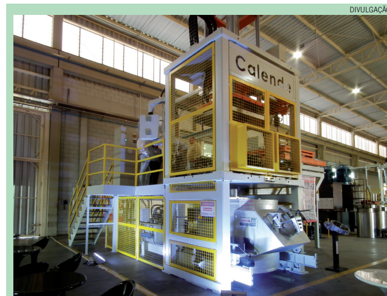
A máquina tem a capacidade de fundir, resfriar, usinar e transportar peças de alumínio em apenas uma célula
